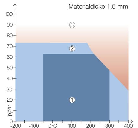
Durch die Streckmetall-Armierung wird die schon hohe Druckstandfestigkeit noch weiter verbessert und eine hohe Festigkeit gegen mechanische Belastungen im Flanschbereich (Dehnung durch Temperaturwechsel) erreicht. Um Druckschwankungen abzufangen, können nun auch höhere Schraubenkräfte aufgebracht werden, ohne die Dichtung zu zerstören. Außerdem bietet die Streckmetall-Armierung einen Ausblasschutz im Schadenfall.
